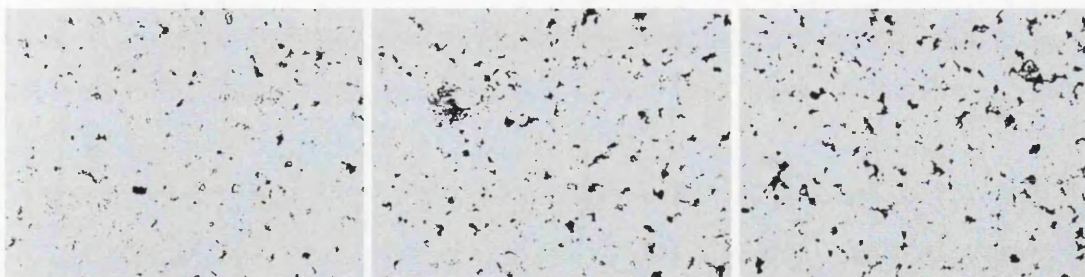
g) 150kN, 0.5% lub, p=1.9\% h) 150kN, 0.25% lub, p=4\% i) 150kN, no lub, p=5.3\%
